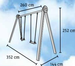
El Columpio Draco es una estructura muy fuerte y resistente. Se trata de combinación del larguero fabricado en acero galvanizado pintado en color verde, los postes en madera tratada en autoclave, la tornillería de acero galvanizado protegida con tapones de nylon y en los laterales embellecedores de polietileno.
